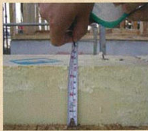
浸水後の断熱材をチェック。水分を含んで変形していることもなく、設計寸法を維持していた
