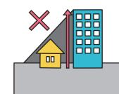
建築物は、前面道路 や隣接地の日照、採 光、通風を確保するた め、「絶対高さ制限」「道 路斜線制限」「隣地斜 線制限」「北側斜線制 限」の大きく分けて4種 類の高さ制限がありま す。「絶対高さ制限」は、
