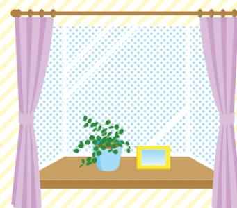
出窓は、建物の外壁よりも外側に突き出した窓のことで、建築基準法では、床面からの高さが30cm以上で外壁から突き出した部分が50cm未満であれば床面積に含まれないと定義されています。外観を西洋風に演出できるうえ、室内空間が開放的になることや、窓が立体的になることでガラス面が広くなり、外光を多く取り入れることができるなど、さまざまなメリットがあります。しかし、その反面、夏は熱がこもりやすく、冬は結露が生じやすくなるなどのデメリットもあるので設置には注意が必要です。一般の住宅で出窓を検討する際は、夏場に暑くなる南側には出窓を設置しない、冬は冷気がたまり結露が発生しやすい北側の部屋は避けておくのが無難でしょう。
